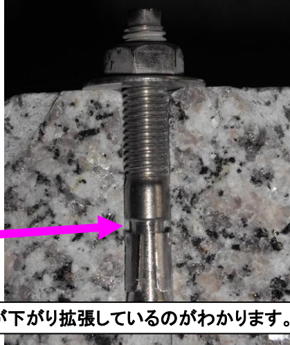
打ち込み後ナットを3回転回した状態
